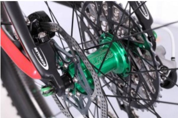
Die AX Lightness Carbonfelgen drehen sich um leichte Tune Naben. Das Gewicht des Laufradsatzes liegt bei unter 1100g für 29"! Geschaltet wird mit der XX1 Einfachgruppe von SRAM mit Kettenblattgrößen zwischen 30-34 in Verbindung mit 10-42 Kassetten.
