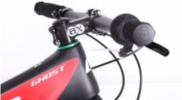
In der Steuerzentrale werden entweder 590€! teure AX Lightness Carbonvorbauten oder Tune „Geiles Teil“ Vorbauten verwendet. Je nach Körpergröße der Fahrerinnen nutzt das Team 620 bis 720mm breite Lenker der Marke AX Lightness oder Engage. Sie wiegen meist unter 100g.
