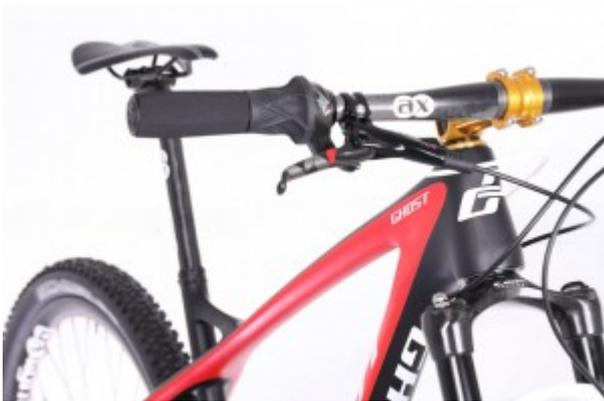
Gebremst wird mit Avid XX Bremsen und gefedert mit einer Rock Shox Sid XX Worldcup mit Carbonkrone und 100mm bzw. reduzierten 90mm Federweg.
