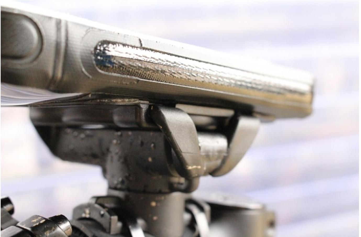
Außerdem ist die Installation des Anchor Points mit Kabelbindern nicht gerade schonend für Parts die von der Montage betroffen sind. Ist Schmutz unter den Kabelbindern zerkratzen die Parts leicht- wie auch mein Vorbau.
