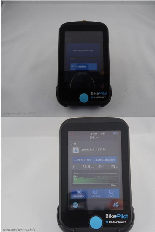
Es lässt sich nach Adressen oder Wegpunkten routen. Die Richtung wird auf der Karte mit einem Positionspfeil angezeigt, der Richtungswechsel mit Signal und Abbiege Pfeil oben links im Display. Während der Fahrt ist der richtige Weg grün hinterlegt. Sollte man vom Radweg der empfohlen wurde abweichen und auf einer anderen Strecke unterwegs sein wird diese grün hinterlegt sofern sie zum Ziel führt.
