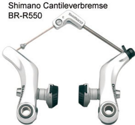
Es gibt aber auch die „klassische Cantileverbremse“ (z.B. von Shimano aus der Alivio Baugruppe). Hierbei handelt es sich um eine Felgenbremse, welche aus zwei unabhängigen steifen Bremsarmen besteht. Diese sind mit einem Querzug miteinander verbunden. Auch diese Bremse ist auf den Canti-Sockeln montiert.
