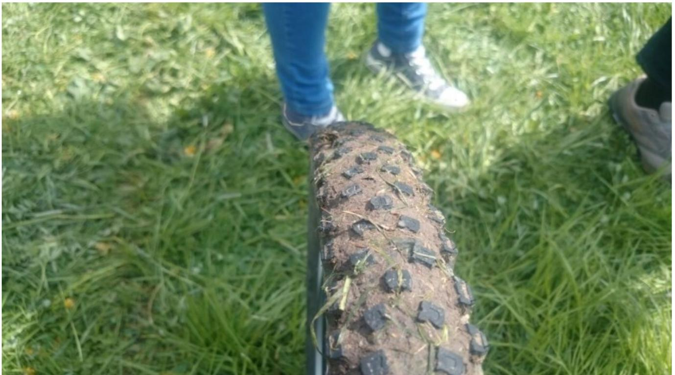
Zugesetzter Reifen an der Front
