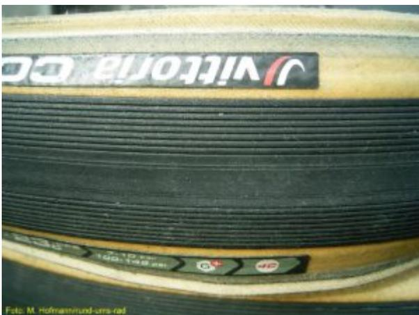
Vittoria Corsa Graphene G+: Nach 3.700 km deutliche Gebrauchsspuren am Hinterrad
