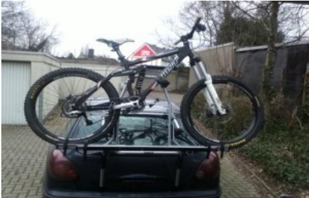
Er wird über ein Hakenspannsystem in wenigen Minuten an der Heckklappe montiert wobei drauf zu achten ist, dass Rückleuchten und Nummernschild sichtbar sind. Denn nur so ist er im Straßenverkehr mit einer ABE nutzbar.
