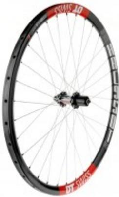
Der MTB Bereich wird um den neuen XRC 950 T Laufradsatz erweitert. Das „T“ steht hier für Tubular und bedeutet, dass der Reifen, wie im Rennradsport, auf die Felge geklebt wird.
