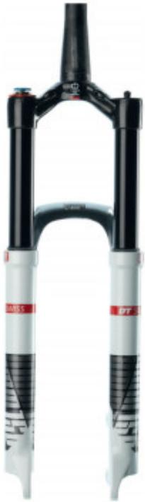
Mit der **XMM 150** wurde eine sehr leichte und steife Magnesium Gabel mit 150 mm Federweg und Twin Shot Damping realisiert. In der Top-Version verfügt diese Gabel über das Twin Shot Damping System, Remote und Tapered Carbon Steerer mit Carbon Krone. Das Gewicht liegt bei knapp 1570 Gramm.
