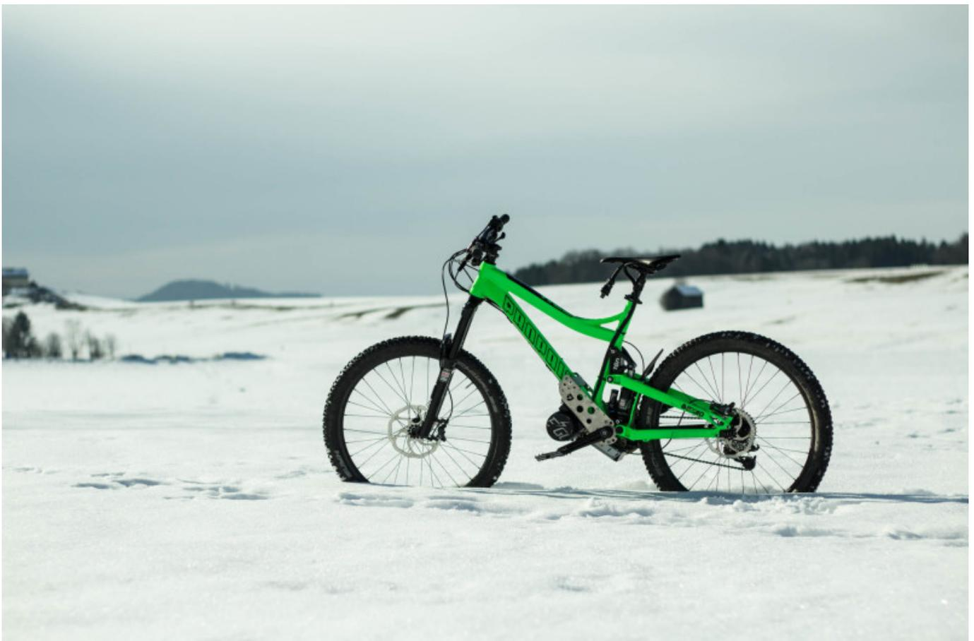
Das fertige Propain Tyee mit dem montierten Ego-Kit 2400 Watt
