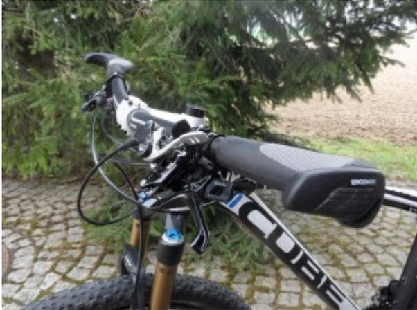
Der Gummi der GP2 ist sehr hochwertig und bietet eine gute Angriffsfläche für die Handschuhe. Dadurch, dass die Griffe mit einer Schraube an dem Lenker befestigt werden kann es auch nicht passieren, dass die Griffe während der Fahrt auf Grund von schlechtem und regnerischem Wetter locker werden.
