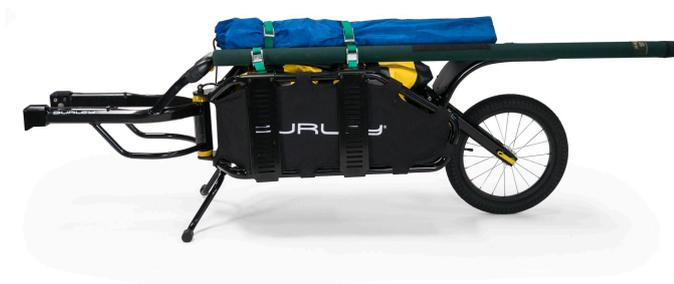
Großzügige Öffnungen an der Seitenverkleidung erlauben die Verwendung von Gurten für eine zusätzliche Sicherung. Trotz abnehmbarer **Seitenwände** aus Textil bleibt das Gepäck so auch ohne Transporttasche sicher verwahrt.
