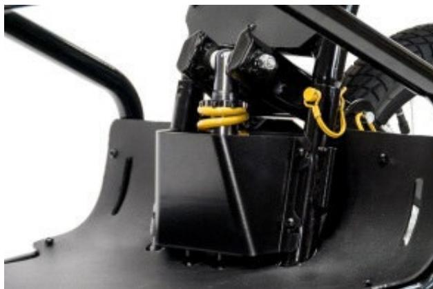
Damit dies möglich ist, hat Burley eine in der **Breite flexible Gabel** entwickelt. Mit Hilfe einer innovativen „**Doppel-Kugel-Kupplung**“ ist ein Befestigen der Gabel in verschiedenen Winkeln möglich. Ergebnis: Mit einem einfachen Griff am Auslösehebel lässt sich der
