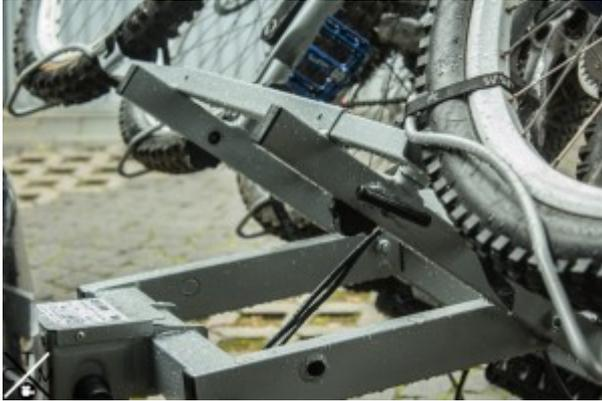
Die schwarzen Hebel betätigen den Mechanismus zum Abklappen.
