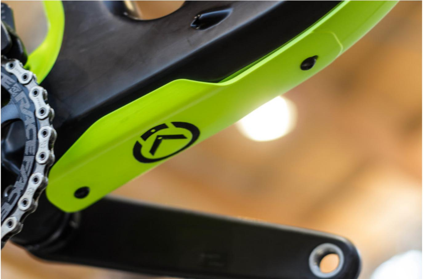
Unter diesem Rahmenschutz wird die Batterie der Di2 sicher verstaut.
