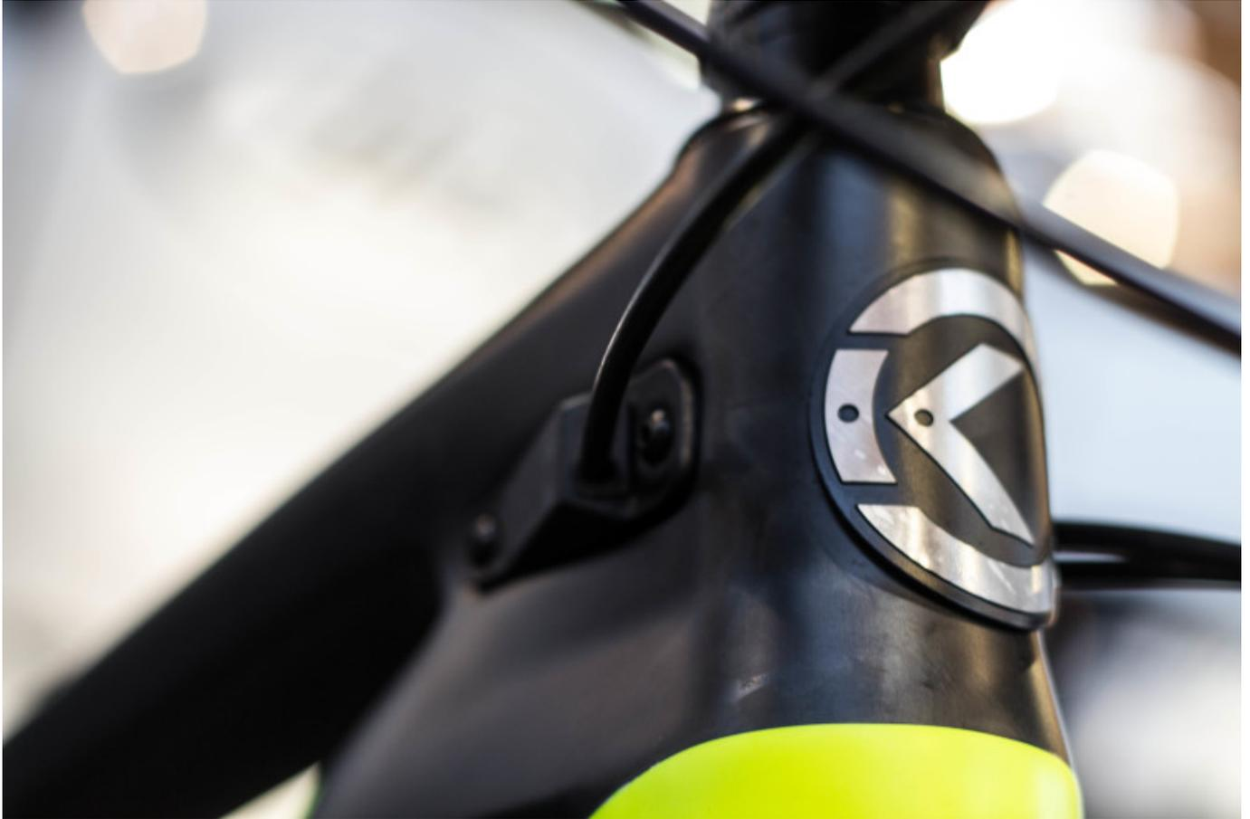
Fein, fein! - Hülsen in verschiedenen Größen ermöglichen die Montage verschiedener Kabelvarianten und verhindern, dass Wasser und Dreck in den Rahmen eintreten kann.
