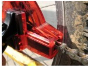
Wenn der rote Kasten dann sauber geschlossen ist, drückt man noch mit dem Daumen der linken Hand auf den Sprayknopf des Reinigungsgerätes und dreht mit der rechten Hand an der Kurbel damit sich die Kette langsam dreht.
