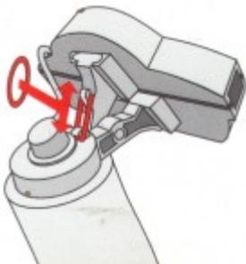
2. Danach das Kettenreinigungsgerät mit der linken Hand ansetzen und mittels des Haltegriffs den roten Kasten schließen.
