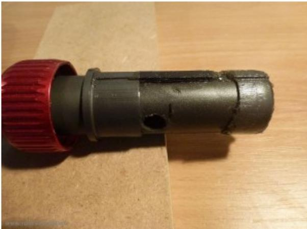
Jetzt kann man das innere Rohr (an welchem der Sattel montiert ist) komplett raus ziehen und zur Seite legen.
