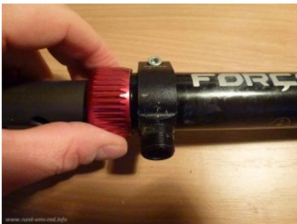
Nun öffnet man die Verschraubung die über dem Anschluss des Arretierbolzens liegt.
