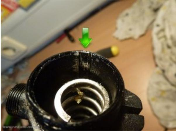
Also einfach das Oberteil wieder in das Unterteil schieben, Verschrauben und fertig ist die Laube. Klar, den Bolzen für die Arretierung und die Remotebedienung natürlich auch wieder einsetzen, sonst könnte es beim nächsten Aufsitzen eine nette Überraschung geben ☐
