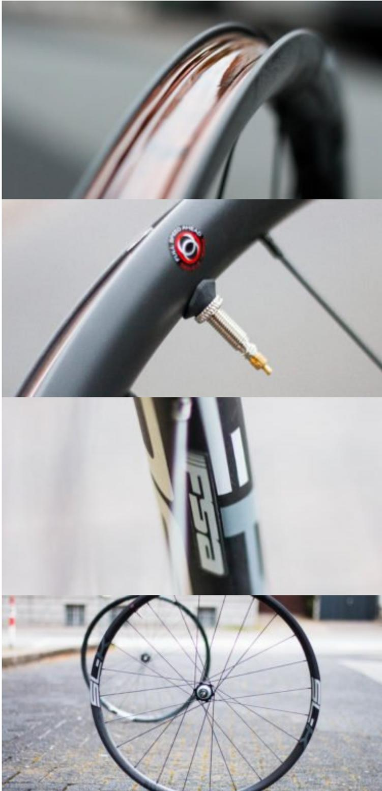
Bei den Speichen fiel die Wahl auf 24 zweifach gekreuzte Straight Pull Speichen. Im Herzstück der Laufräder arbeitet eine 6-fach Pawl Aluminium Freilaufnabe, deren Lager in 2 Reihen angeordnet sind und so für ein langlebiges und direktes Ansprechverhalten sorgen sollen. Zur Wahl stehen selbstverständlich Shimano und SRAM XD-Freiläufe, sowie 135mm und 142mm Achsbreiten.
