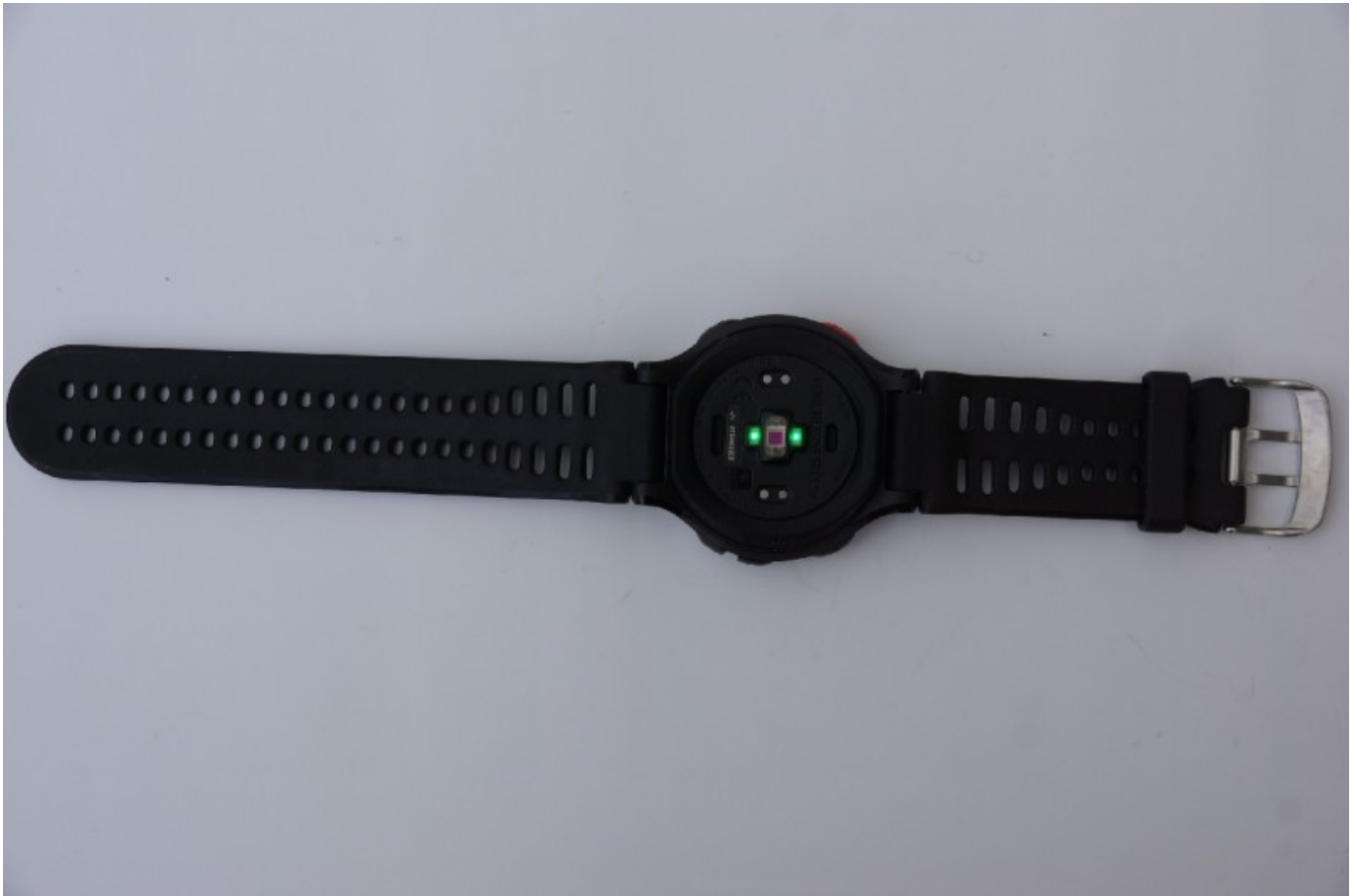
Garmin Forerunner 225 Rückseite mit Messsystem
