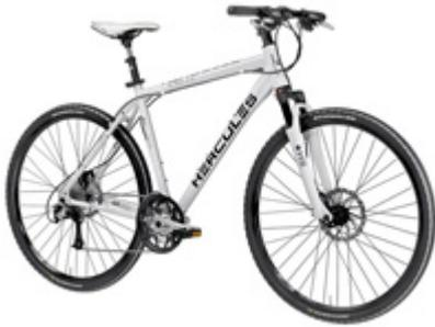
Der Diamant unter den Crossern von Hercules ist der „Exell Cross“. Die Ausstattung besteht aus der hydraulischen Scheibenbremse Magura Julie, einer kompletten Shimano XT-Schaltgruppe und eine vollständig blockierbare Federgabe von RST.
