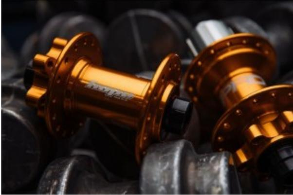
Außerdem wurde auch im inneren der Nabe was getan. Die größeren Flansche bieten mehr Bauraum und so kommt eine neue Ratsche mit 44 Zähnen am Freilauf zum Einsatz. Dies reduziert den Leerweg und lässt die Nabe beim Reintreten schneller einrasten. Kunden und Liebhaber der Pro 2 müssen dennoch keine neuen Standards befürchten. Die Pro 4 Naben verwenden die gleichen Endanschläge bzw Umbaukits wie die Pro 2 Evo Naben und alle gängigen Achsvarianten (auch Boost) werden angeboten.
