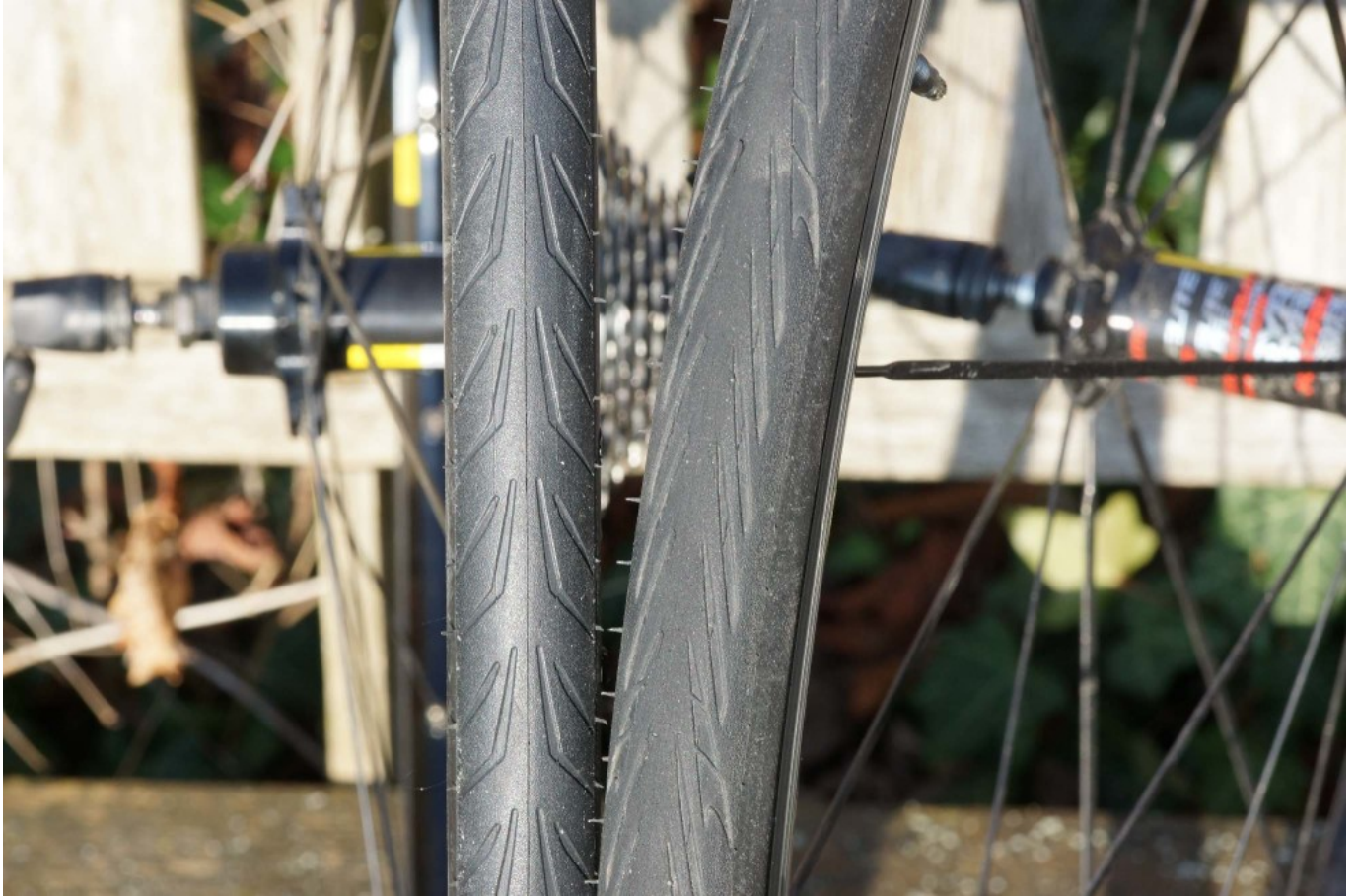
Hutchinson Fusion 5 All Season nach knapp 2.000 km im Vergleich mit neuem Mavic Yksion Pro Powerlink
