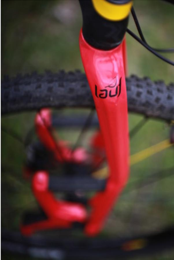
Luftfedergabeln arbeiten nach einem bekannten Konzept: Die Tauchrohre der Federgabeln verschwinden je nach Krafteinwirkung im Casting der Gabel und geben so Federweg frei, ähnlich wie bei einem Stoßdämpfer am Auto.
