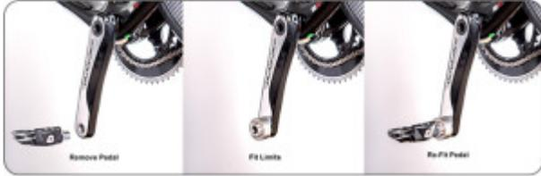
Fraglich ist derzeit jedoch noch, wie sich der erhöhte Q-Faktor, der Abstand der Pedale zur Tretlagermitte, auswirken wird. Auch wenn noch keine genauen Maße veröffentlicht wurden, wird das System definitiv die Tretergonomie etwas verändern. Der Hersteller gibt an, dass mit der Einstellung der Schuhplatten entgegen gesteuert werden kann und außerdem ein erhöhter Q Faktor für bessere Ergonomie sorgen kann. Wir sind gespannt auf erste Expertenmeinungen und Erfahrungen.
