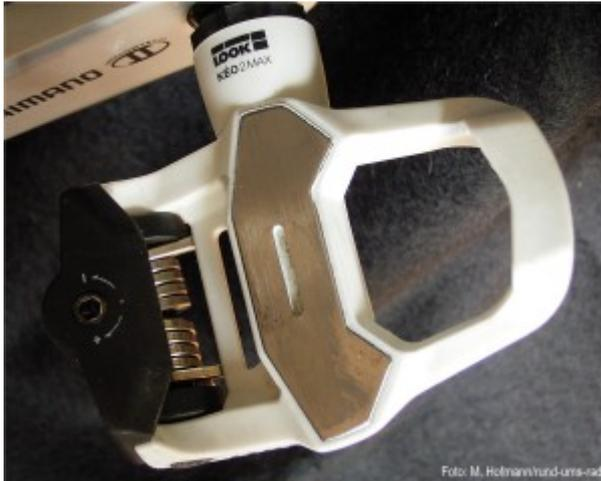
Optimaler Verschleißschutz dank Edelstahlplatte
