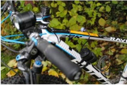
Mittels eines Gummiringes kann man die Magicshine ganz einfach am Lenker montieren. Wie auch bei den anderen Testlampen saß die Lenkerhalterung bombenfest. Den Akku fixierten wir mit den Zurrbändern am Unterrohr. Durch die Textilverkleidung blieb der Fahrradrahmen von Kratzern verschont und der Akku saß fest. Für 6,99€ lässt sich außerdem eine Helmhalterung erwerben.
