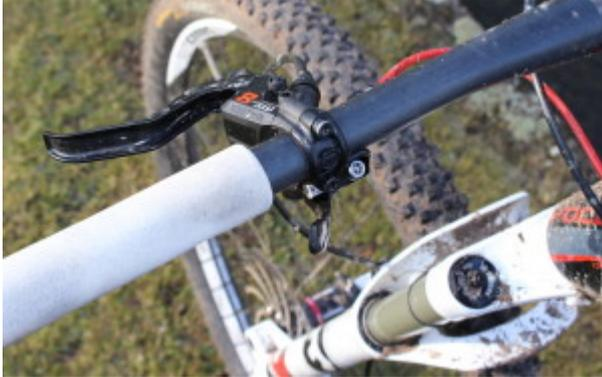
Um das Gesamtgewicht etwas zu senken und vorallem um eine aufgeräumte Optik am Lenker zu erlangen, bietet Magura die Shift Mix D Schellen. Mit ihnen können Bremsgriff und SRAM Schalthebel an einer Schelle montiert werden.
