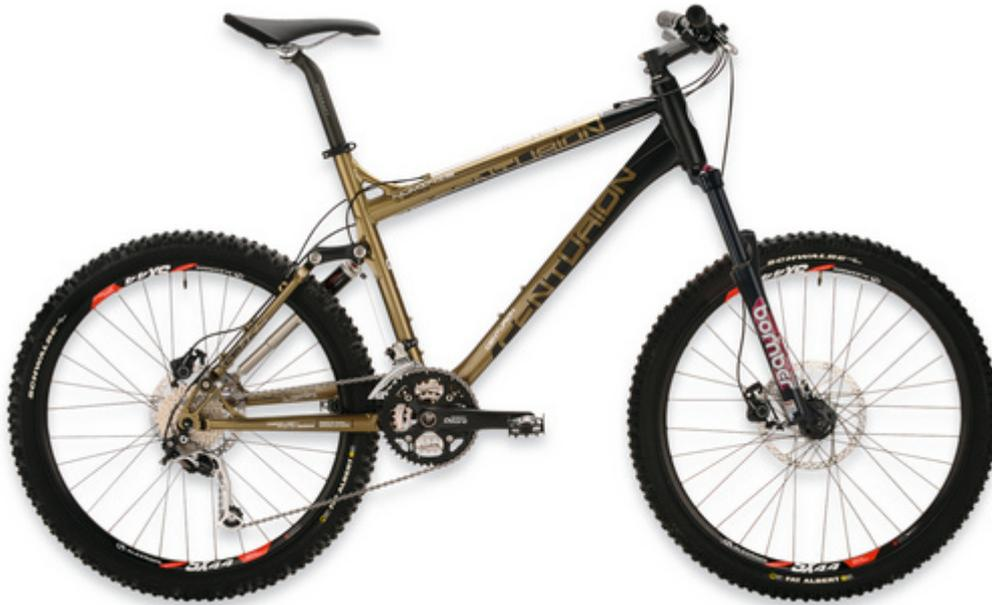
Typischer Mehrgelenker - © Merida&Centurion
