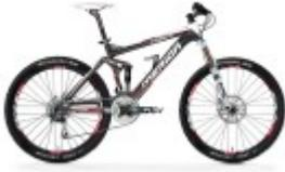
In der 120mm-Klasse die neue Referenz in Steifigkeit und Rahmengewicht. 1860 Gramm bringt der neue Carbon-Allrounder bei 46 cm Rahmen ohne Federbein auf die Waage. 2,1 kg sind es mit DT Swiss M210 Federbein. Das sind aber gerade einmal 160 Gramm mehr als der Race-Klassiker NINETY-SIX! Die gute Steifigkeit des MERIDA Race-Fullys konnte dabei nochmals um knapp 20% verbessert werden.
