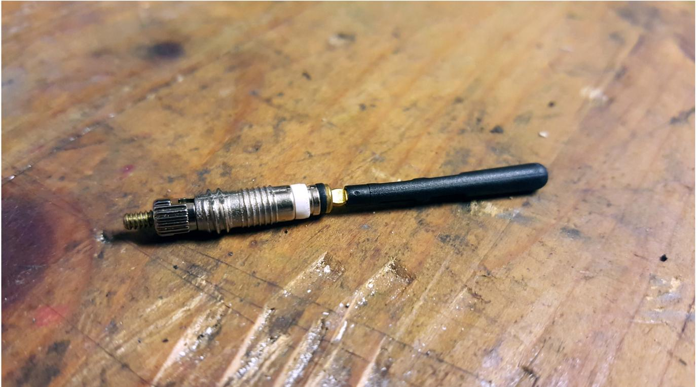
korrekte Positionierung der Verlängerung
