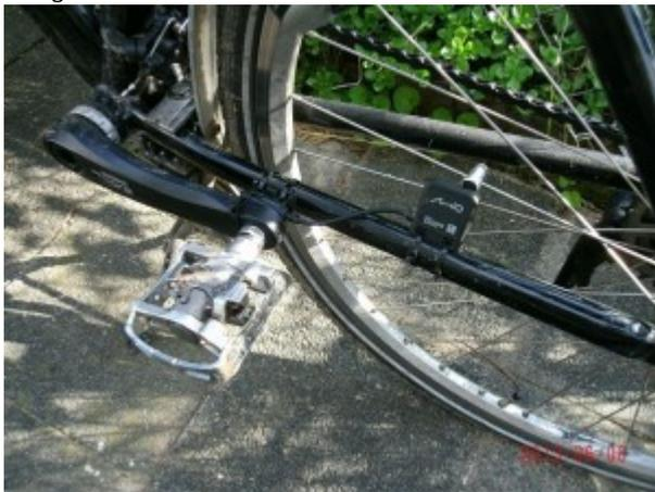
Der Abstand zwischen Magneten und Sensoren darf nur 3 bis 5 mm betragen, bei gerader Montage ist dies bei den Kadenz Sensoren nicht zu erreichen, zum Glück bin ich auf die Idee gekommen den Sensor schräg zu den Speichen zu stellen so konnte der geforderte Abstand erreicht werden.
