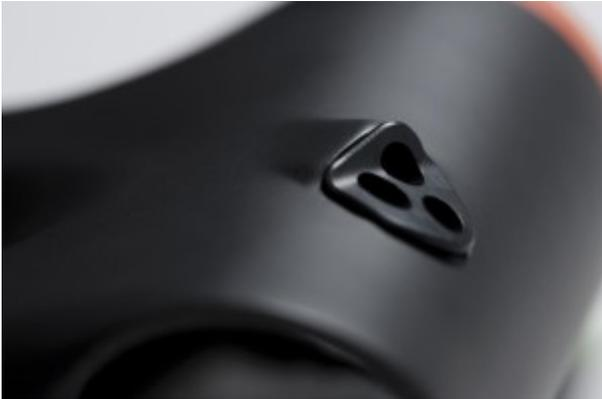
Multistop Kabelführung. Der Rahmen wird nur durch ein Loch statt durch mehrere „geschwächt“ und die Kabel werden ordentlich gebündelt
