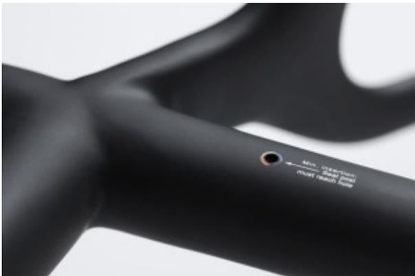
Ein einfaches Loch im Rahmen zeigt, ob die Sattelstütze weit genug im Rahmen steckt, um die Kräfte besser zu verteilen und den Rahmen zu schützen.
