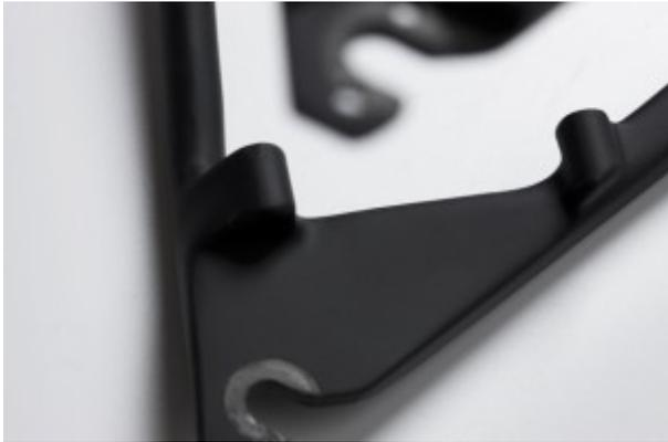
Minimalistische Scheibenbremsaufnahme an der Kettenstrebe
