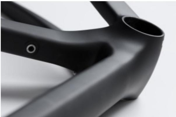
BBright Innenlager mit großer Breite und Durchmesser für viel Steifigkeit, passend für Shimano, SRAM, Rotor, THM Lager
