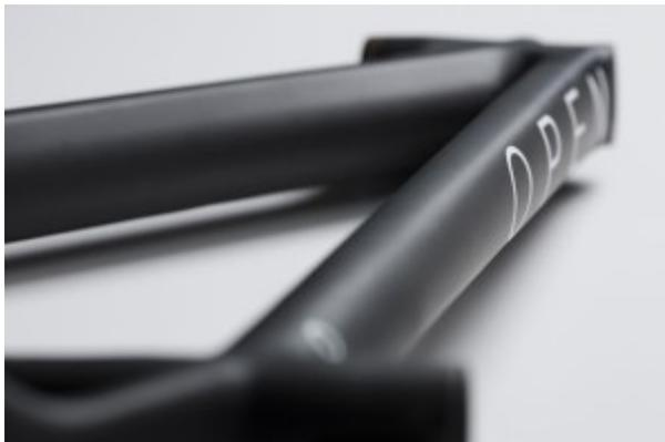
Ein trapezförmiges Oberrohr soll die Kräfte im Steuerrohrbereich perfekt aufnehmen und verjüngt sich gewichtsreduzierend zum dünnen Sitzrohr.
