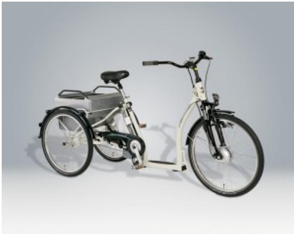
„Was dem Autofahrer das Automatik-Getriebe, ist dem E-Trike-Fahrer der Schalt-Assistent. Zumindest, wenn er ein PFAUTOMATIK fährt“, unterstreicht PFIFF-Geschäftsführer Martin Schroedter das Hauptargument des gerade auf dem Markt gekommenen Dreirads: „Über Schaltvorgänge bei zugeschaltetem Elektroantrieb muss sich der Fahrer keine Gedanken mehr machen, da der Assistent dies komplett abnimmt.“
