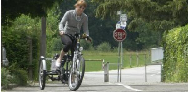
Ein starres Dreirad steht zwar im Stillstand fest auf dem Boden, gerade bei Kurvenfahrten oder auf abschüssigen Wegen wird diese Stabilität jedoch stark vermindert, denn die Kippkräfte können nicht durch Neigung ausgeglichen werden.
