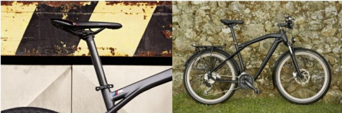
Innovationen sind nicht nur in der neuen Formensprache sicht-, sondern auch in den technischen Details spürbar. Neben Neuerungen aus dem eigenen Hause, wurden Komponenten renommierter Hersteller wie Shimano und Suntour verbaut. Der Mehrwert des hydrogeformten Rahmens ist seine hohe Steifigkeit und das geringe Gewicht. So garantiert er eine optimale Effizienz, das heißt eine maximale Kraftübertragung bei möglichst geringem Aufwand.
