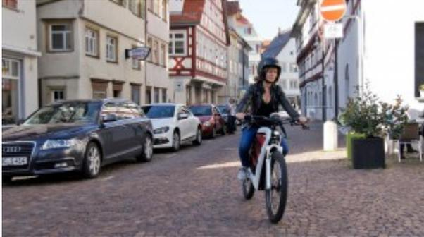
Das FEDDZ ist ein völlig neues Elektro-Kleinkraftrad mit einem bürstenlosen Hinterradnabenmotor, mit zwei Ausführungen zu 25 km/h schnell oder zu 45 km/h (Moped-Führerschein, aktuelle Bezeichnung Klasse AM oder Autoführerschein Klasse B oder BF 17).
