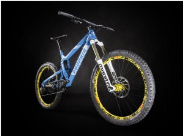
Für die Saison 2015 hat das SPINDRIFT den gleichen neuen und leichteren Rohrsatz wie das *RAGE* bekommen. Dieser Rohrsatz, mit neuen geschmiedeten Elementen an der oberen Lagerung des Hauptrahmens, wiegt ca. 150g weniger als der des 2014er Modells. Durch eine neue Formgebung in Kombination mit veränderten Fräsungen haben die Jungs von PROPAIN Bikes dem SPINDRIFT einen auffallend cleanen und hochwertigen Look verpasst.
