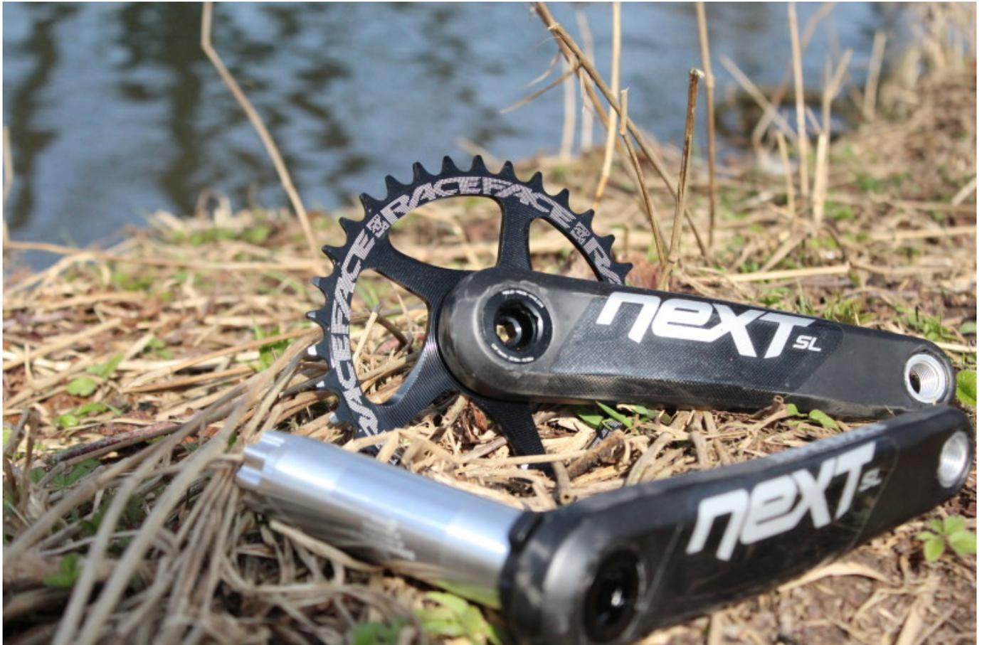
Direkt ist klar, diese Kurbel soll den Markt erobern. Die Features könnten beinahe zu einem Sportwagen gehören. Hohle Carbonachsen, ultraleichtes Aluminium, das 20% gegenüber dem herkömmlichen 7050 einspart, neuartige Cinch Verschraubungen und Lager, sowie eine große Auswahl an Direct Mount Kettenblättern und Kurbelsternen.
