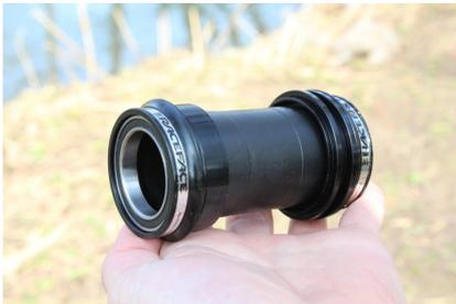
Wir testeten die Kurbel mit einem 34er und einem 32er Direct Mount Kettenblatt, sowie PF30 Lagerschalen. Auch bei diesen gibt es wieder etwas besonderes zu vermerken. Die eigentlichen Industrielager sitzen außerhalb des Rahmens. Der Kontaktpunkt zwischen Kurbel und Lager ist somit weiter außen, was die Steifigkeit und Langlebigkeit der Lager erhöhen soll.
