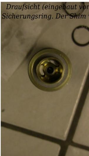
Draufsicht (eingebaut von unten) auf den Kolben, ohne Sicherungsring. Der Shim vom Rücklaufventil ist sichtbar
