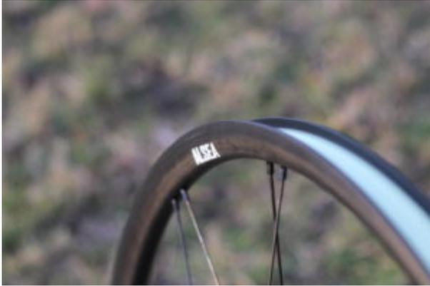
Für einen sicheren Sitz der Reifen weisen die Carbon-Felgen eine Innenweite von 23mm auf. Auch bei niedrigem Reifendruck sollte so ein sicherer Sitz gewährleistet sein. Schon von Werk aus sind die Felgen mit Tubeless Band und Ventilen ausgestattet. Die Reifenmontage geht sehr einfach von der Hand und mit Hilfe eines Kompressors benötigte die Tubeless-Montage nur wenige Sekunden. Der Reifen rutscht schnell ins Felgenbett und das Felgenband hält dicht.
