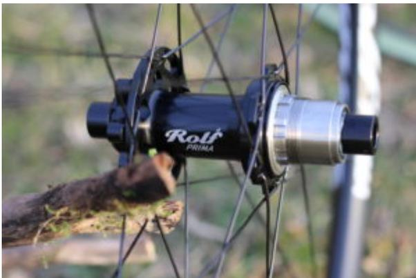
Auch bei den Naben haben sich die Amerikaner eigene Gedanken gemacht. Der Nabenflansch auf der Nicht-Antriebsseite fällt im Durchmesser deutlich größer aus als auf der Antriebsseite. Der dadurch veränderte Speichenwinkel soll ebenfalls zu erhöhter Steifigkeit beitragen. Ein weiteres Schmankerl ist der aus Titan gefräste Freilaufkörper. Hier wird sich im Gegensatz zu Alu so schnell keine Kasette einarbeiten!
