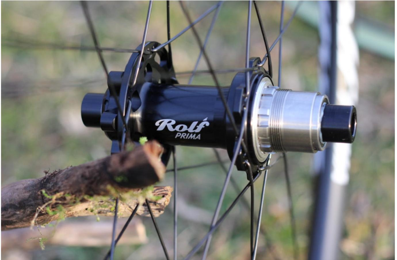
Auch bei den Naben haben sich die Amis etwas einfallen lassen. Der Nabenflansch auf der Nicht-Antriebsseite fällt im Durchmesser deutlich größer aus als auf der Antriebsseite. Der dadurch veränderte Speichenwinkel soll ebenfalls zu erhöhter Steifigkeit beitragen. Ein weiteres Schmankerl ist der aus Titan gefräste Freilaufkörper. Hier wird sich im Gegensatz zu Alu so schnell keine Kassette einarbeiten!
