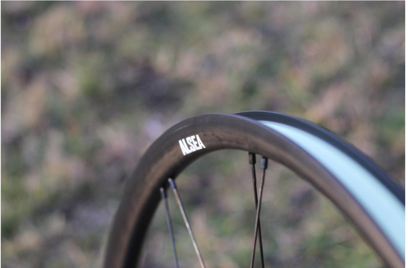
Die Carbonfelge weist eine Innenweite von 23mm auf. Auch bei niedrigem Reifendruck sollte so ein sicherer Sitz gewährleistet sein. Schon von Werk aus sind die Felgen mit Tubeless Band und Ventilen ausgestattet. Die Reifenmontage geht sehr einfach von der Hand und mit Hilfe eines Kompressors benötigte die Tubeless-Montage nur wenige Sekunden.
