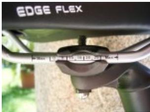
Die Montage erfolgte ohne größere Probleme. An der rechten Strebe befindet sich eine in halbe Zentimeter eingeteilte Skala, mit der sich der Sattel in der Horizontalen sehr genau positionieren lässt.
