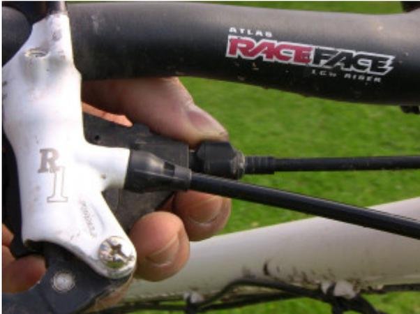
Klettert die Kette nicht auf das nächstgrößere Ritzel, spannen Sie den Zug mit Hilfe der Einstellschrauben am Schalthebel stärker vor. Tun Sie das umgekehrte, wenn die Kette nicht auf das nächstkleinere fällt.
