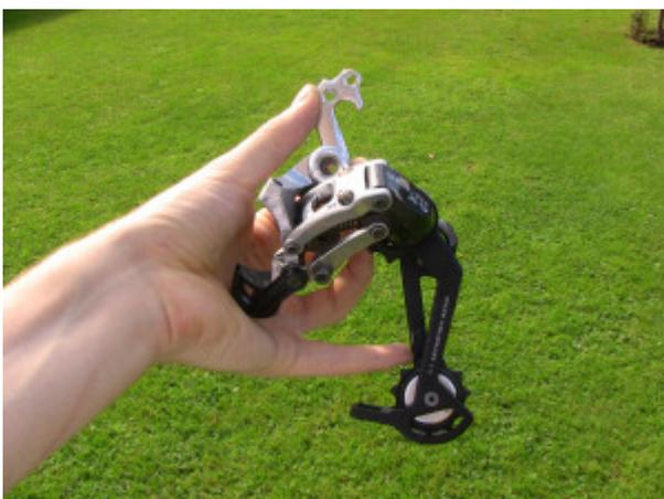
**2.)** Nun führen Sie die Kette durch das Schaltwerk und verschließen Sie die Kette mit einem Kettenschloss oder einem Niet.
