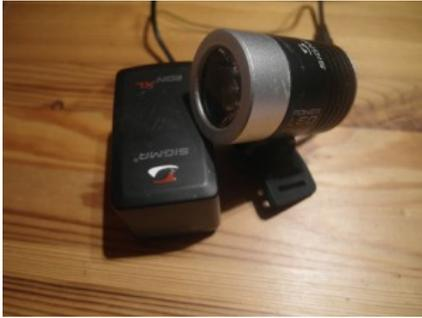
Die Sigma Powerled Evo wiegt laut Hersteller 140 Gramm, beim Nachwiegen kamen 158 Gramm heraus. Die Lichtmenge beträgt bis zu 900 Lumen und weist 4 Modi auf: Energiespar-, Standard-, Power- und Blinkmodus.
