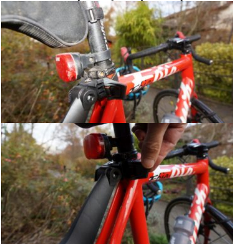
SKS S-Blade befestigen (1):Spannbügel einhängen
