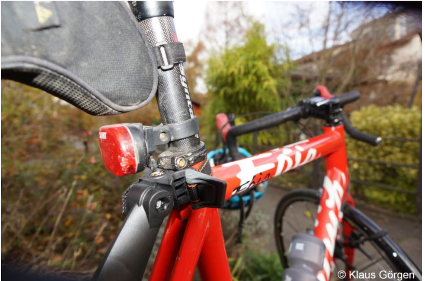
SKS S-Blade befestigen (1):Spannbügel einhängen
