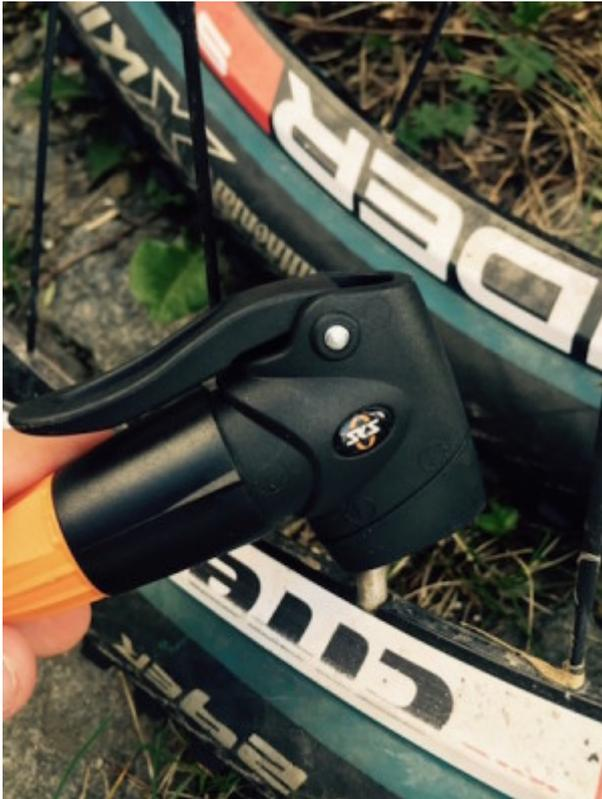
Ist der Adapter nicht im 90 Grad Winkel aufgesteckt gelangt die Luft nicht in den Schlauch.
