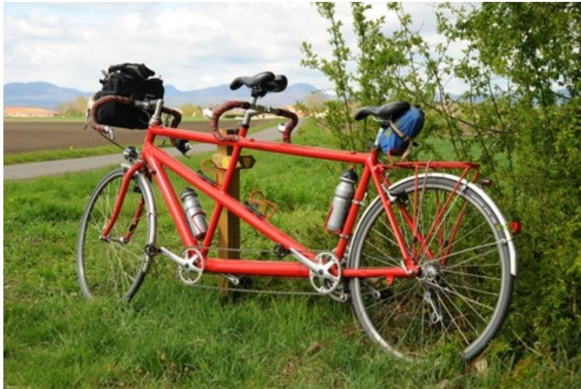
Mit dem Tandem kann auf der Ebene gegenüber dem üblichen Fahrrad eine viel höhere Geschwindigkeit erreicht werden. Dies liegt daran, dass der Rollwiderstand und die Stirnfläche des Tandems denen eines normalen Fahrrades gleich sind, im Unterschied zum üblichen Fahrrad aber hier zwei Personen in die Pedale treten.
