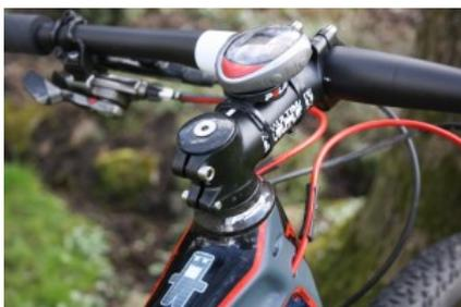
Mit den Maßen von +/- 7 Grad im FlipFlop-Design und den in 10mm Schritten erhältlichen Längen von 70-130mm ist der Vorbau in der bekannten Norm und für fast jeden Zweck passend. Wieder steht eine Farbauswahl (schwarz oder weiß) bereit. Luxuriöse Titanschrauben helfen das super Gewicht in Höhe von 104g zu erreichen. Aus dem Portmonee müssen dafür jedoch 99€ entnommen werden. Auch bei diesem Produkt konnte ich trotz Leichtbau keine Steifigkeitsprobleme feststellen.
