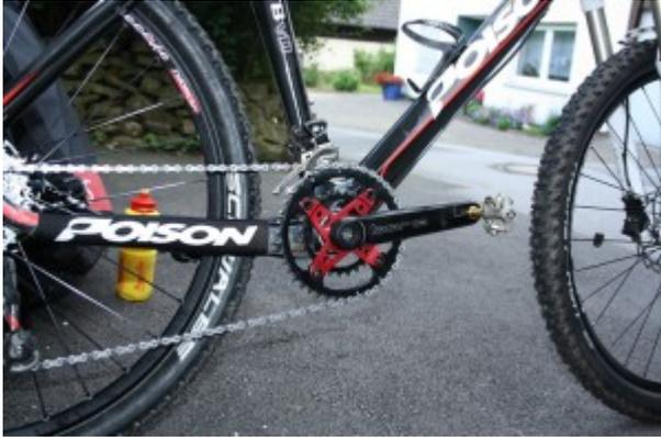
Die beiden Kurbelarme, sowie die Achse stellen die Basis für dieses neuartige Baukastensystem dar und können für alle erdenklichen Lager-/Kettenblatt-Kombinationen verwendet werden. Es stehen etliche Spider (Befestigung der Kettenblätter) bereit und 2-fach, 3-fach oder XX1 Übersetzungen können geordert werden. Die Integration von Systemen zur Leistungsmessung ist ebenfalls möglich. Zur perfekten Anpassung stehen mehrere Farben bereit.
