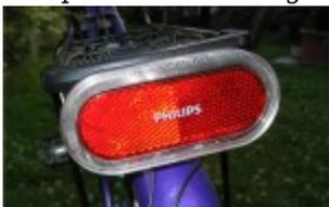
Das Rücklicht findet seinen Platz an der Halterung des Gepäckträgers. Die variable Befestigung lässt sich an Lochabständen von 50 mm oder 80 mm befestigen.
