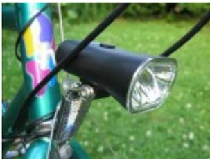
Bei der Montage wird anstelle der alten Lampe die Philips SafeRide montiert. Dazu musste lediglich eine Schraube gelöst werden.
