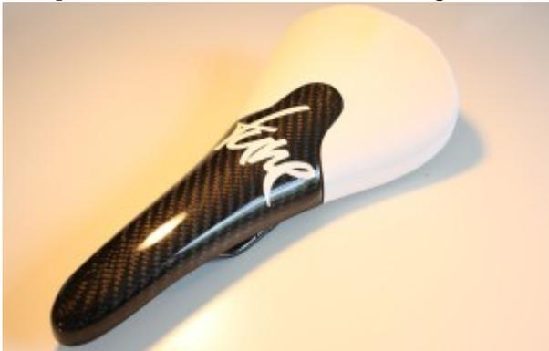
Das Lackfinish ist gut gelungen und die Carbonlagen sind perfekt verarbeitet. Wer nach Fehlern sucht, könnte an der Unterseite kleine Kratzspuren im Vorderbereich erkennen.
