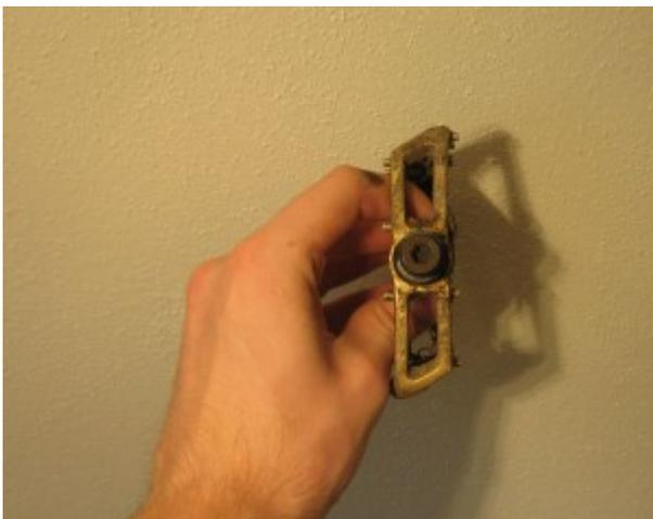
*Pedalachse ohne Flansch erzeugt durch die Momentabstützung unter Last in Abhängigkeit der Gewindeausrichtung eine unterschiedlich große Materialspannung und kann Deformation hervorrufen. Bei solchen Achsen mit Unterlegscheiben arbeiten.*
