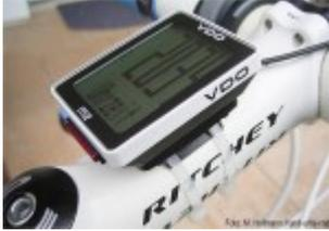
Die Halterung des M2 lässt sich durch Lösen von vier Schrauben abnehmen und um 90° drehen, sodass man den Computer am Lenker als auch am Vorbau montieren kann. Ein Klebepad an der Kontaktfläche zum Lenker oder Vorbau verhindert zuverlässig ein verrutschen.
