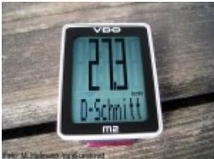
Der VDO M2 bietet, neben der Wahl von mehreren Sprachen, alle Grundfunktionen plus die Anzeige und Speicherung der Durchschnittsgeschwindigkeit sowie der maximal erreichten Geschwindigkeit. Ob man während der Fahrt über oder unter dieser liegt, wird mit einem kleinen Pfeil nach oben bzw. unten am Display angezeigt.
